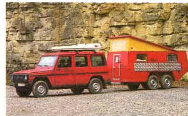
Bei ausgefahrenem Hubdach können auch übergroße Off-Roader aufrecht in dem rund vier Meter langen Geländeanhänger stehen.
