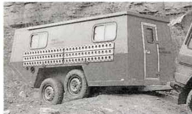
Auf Erhebungen lasten jeweils 50% des Gesamtgewichts auf den beiden Achsen der Gelände-Tandem-Achskonstruktion.
